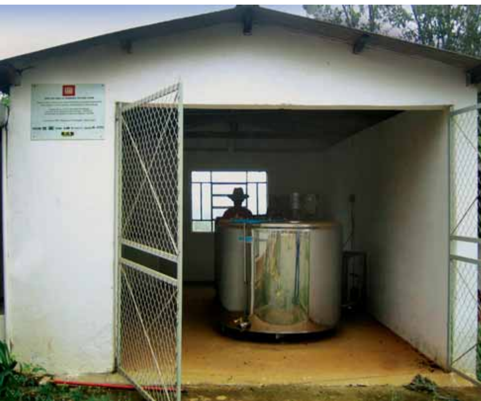
Tanque de expansão para armazenamento de leite – município de Carvalhópolis – Minas Gerais
