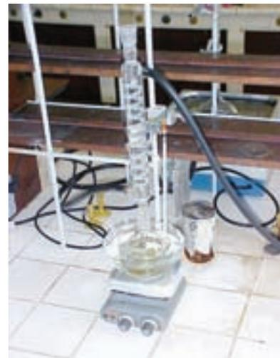
Figura 5.12 – Aparelhagem de refluxo usada nas reações homogêneas.
