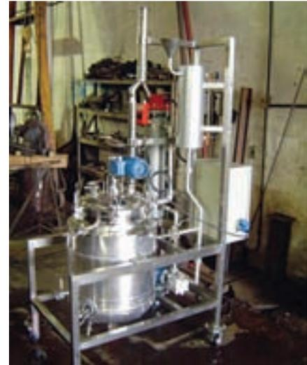
Figura 5.16 – Unidade móvel de produção de biodiesel
