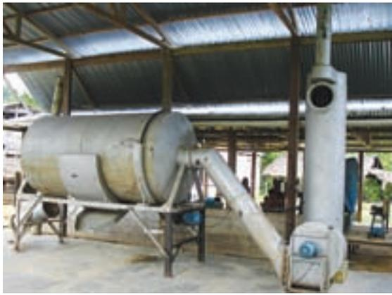
Figura 8.6 – Secador de semente rotativo – Roque
