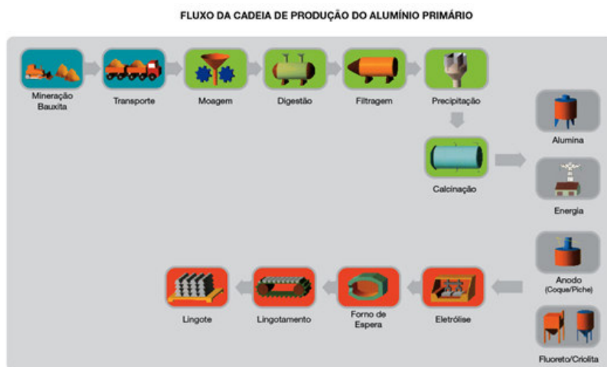
Figura 3: Ilustração da cadeia de produção do alumínio primário
