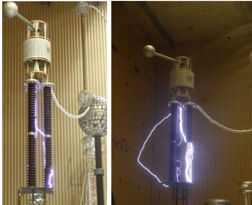
Figura 10 – Fotos obtidas com câmera fotográfica comum exposta durante todo o tempo de ensaio de verificação de tensão suportável, 885 kV, sob chuva de 5 mm/min
